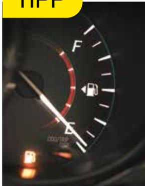
An der Anzeige der Tankuhr gibt es neben der Tanksäule einen Pfeil. Dieser zeigt immer in die Richtung, wo sich die Tanköffnung befindet. Sehr praktisch, wenn man mit einem fremden Auto oder einem Mietwagen unterwegs ist. So fährt man immer an die richtige Seite der Tanksäule und braucht den Schlauch nicht über das Auto ziehen.
