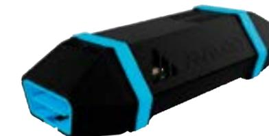
Dieser Dongle wird an der OBD Schnittstelle angesteckt und liefert nach der Testfahrt exakte Ergebnisse.
