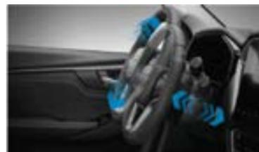
Lenkrad – höhen- und weitenverstellbar
