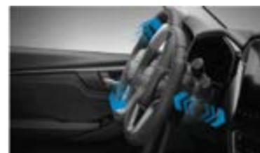
Lenkrad – höhen- und weitenverstellbar
