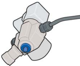
manueller Absperrhahn am Fuß des Flaschenventils.
