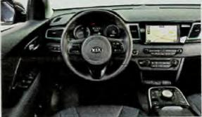
Kia e-Niro: Übersichtliche Anzeigen und schnell durchschaubare Bedienung. Statt eines Automatikhebels gibt es einen Drehknopf
