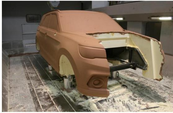
Motorraum + Motor-Dummy
