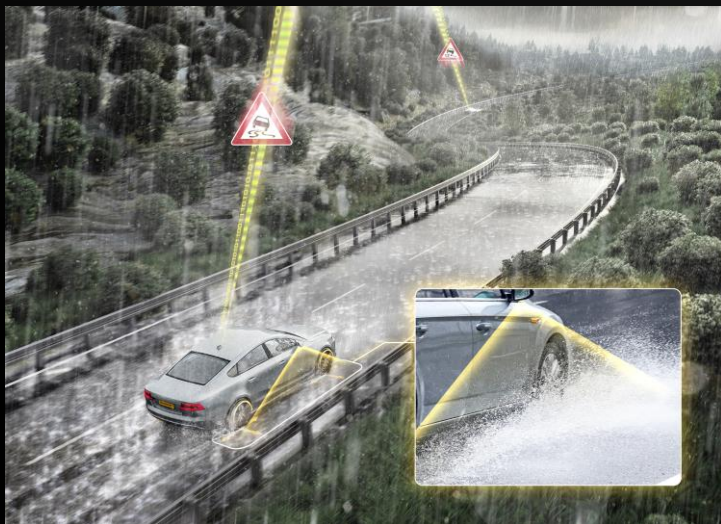
Spritzwasser-Erkennung über Surround View Kameras
