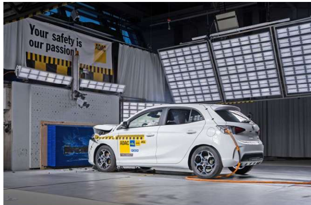
Fahrzeug im Crashtest gemäß Euro NCAP-Norm
