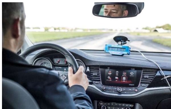
Fahrleistungsmessungen mittels GPS-Messsystem
