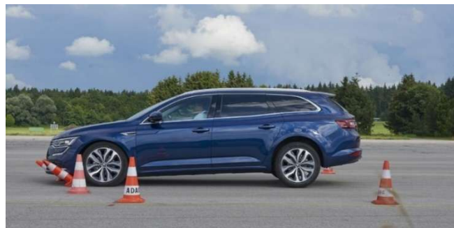
Fahrzeug beim Bremstest aus 100 km/h
