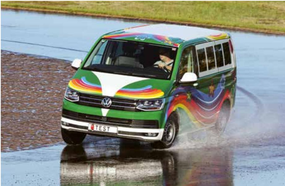
Die Benotung bei Nässe setzt sich aus Aquaplaning (längs und quer), Bremsen, Handling und Seitenführung zusammen.
