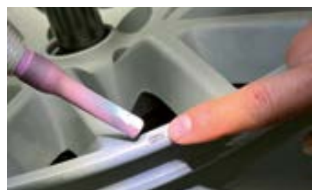
Mit dem Laser wird die beschädigte Stelle Schicht für Schicht aufgefüllt.
