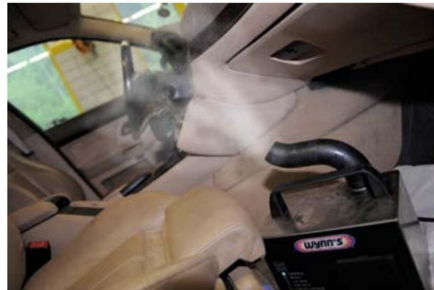
Bei der ÖAMTC-Ultraschallreinigung desinfiziert Rauch das Heizungs- und Lüftungssystem sowie das Fahrzeuginnere.
