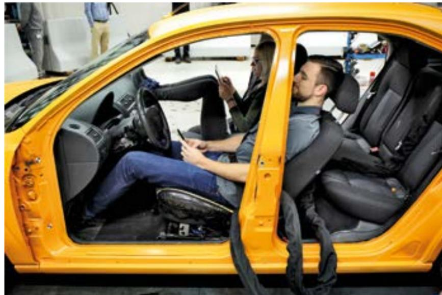
Stark zurückgelehnt oder Füße auf dem Armaturenbrett – tödliche Verletzungen bei 30-km/h-Crash möglich
