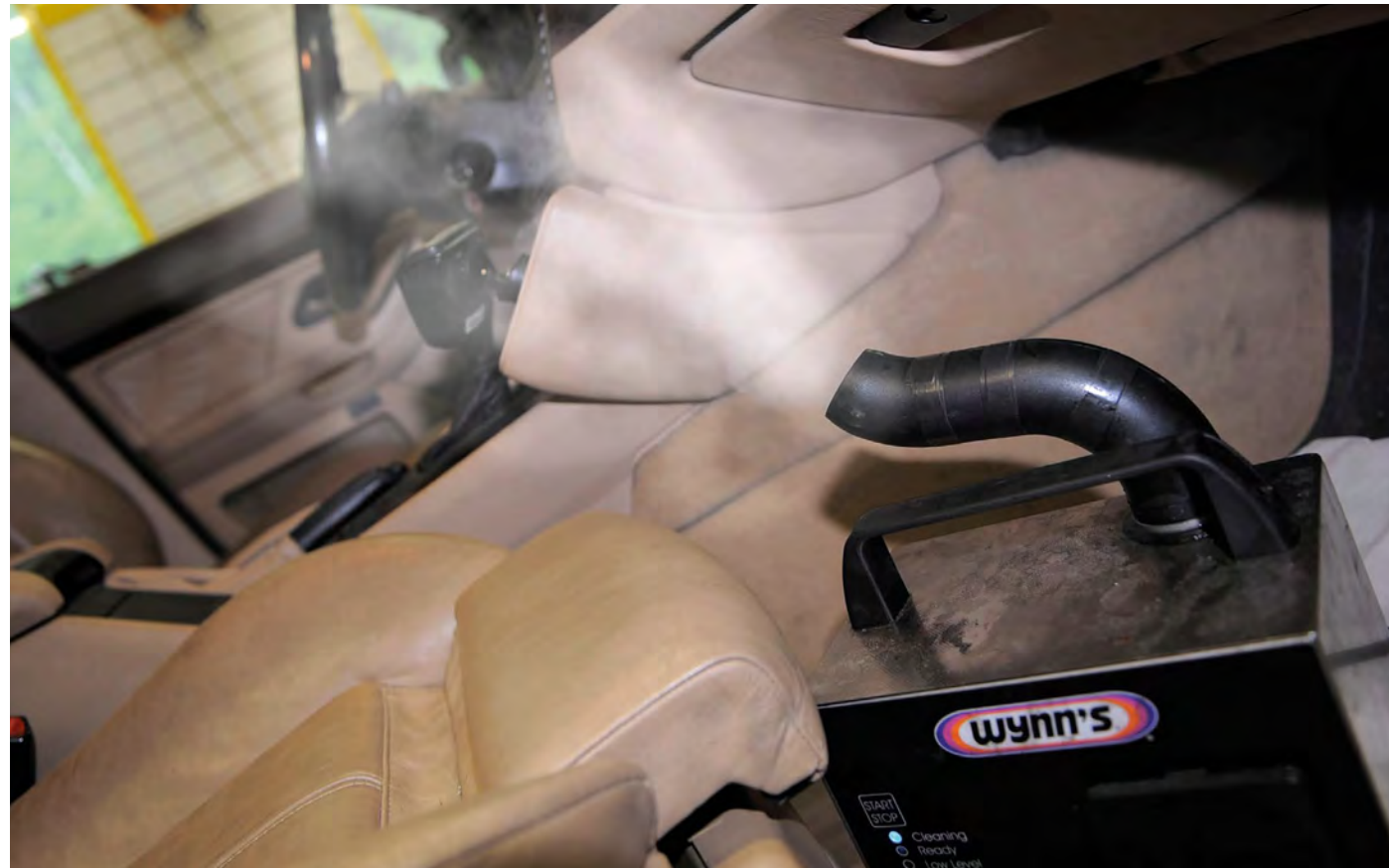
Bei der ÖAMTC-Ultraschallreinigung desinfiziert Rauch das Heizungs- und Lüftungssystem sowie das Fahrzeuginnere.
