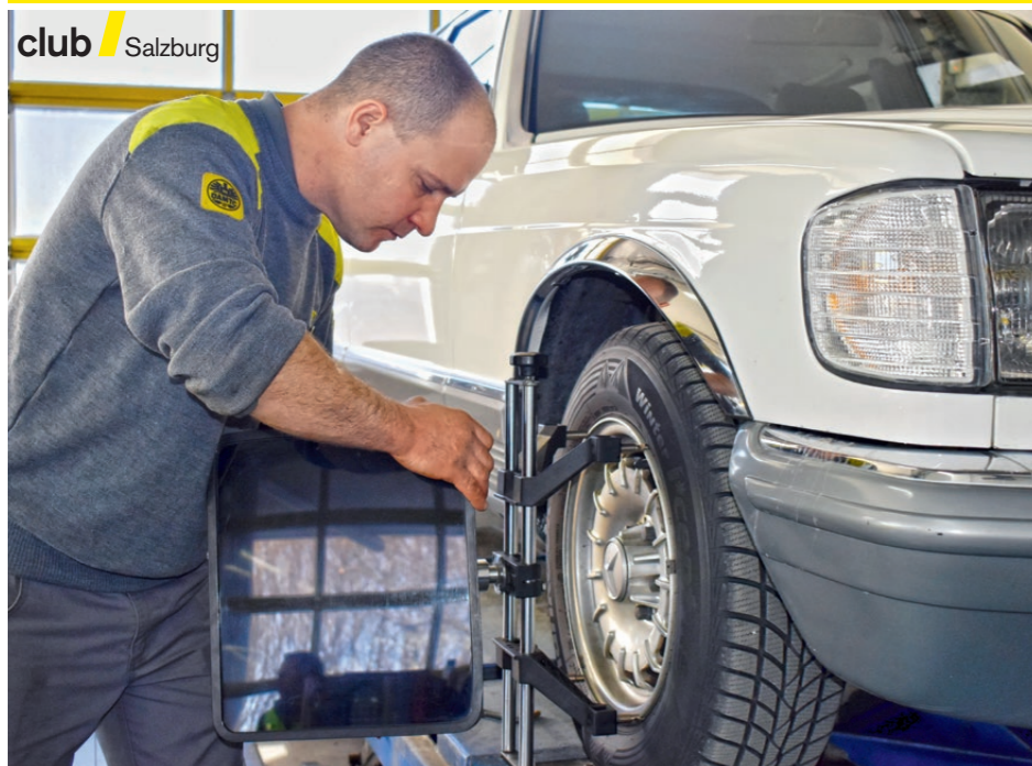
Achsvermessung mit Hightech-Präzision. Kameras und Spiegel erkennen kleinste Abweichungen.
