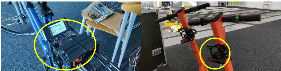
Abbildung 8: montierte Datenlogger an Fahrrad und E-Tretroller
