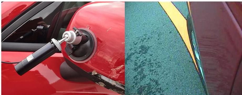
**Abbildung 12:** Kamera zur Erfassung der Spur (links) und damit aufgezeichnetes Videobild (rechts)
