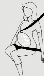
Position und Verlauf des Fahrzeuggurtes mit Schwangerschaftsgurt.
