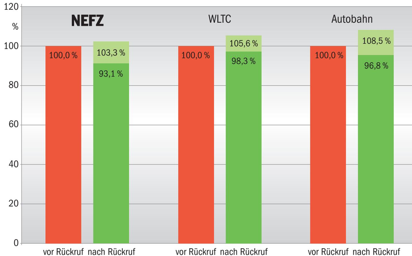
Bandbreite der maximalen Leistung von 9 getesteten Fahrzeugen nach dem Rückruf
