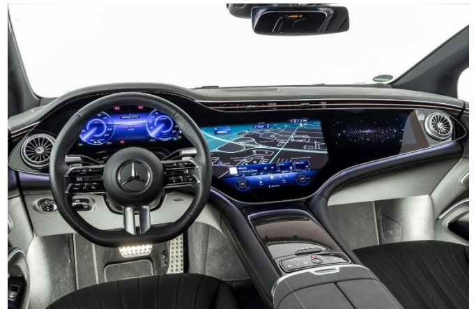
Das primär über berührungsempfindliche Oberflächen zu bedienende Cockpit lenkt während der Fahrt stark vom Verkehr ab.
