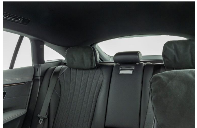
Die Sicht nach hinten ist wegen den nicht versenkbaren Kopfstützen und den sehr breiten D-Säulen schlecht.
