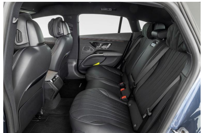
Limitierend im Fond ist die Kopffreiheit, welche durch die abfallende Dachlinie für Personen bis 1,90 m Körpergröße genügt.
