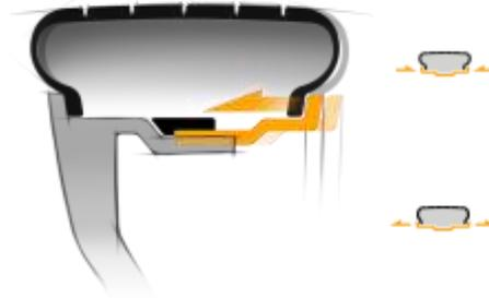
Änderung des Luftdrucks zwischen 1 und 3 bar innerhalb von weniger als 2 Minuten
