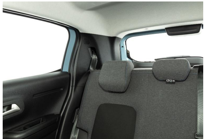
Die Rundumsicht wird vor allem durch die sehr breiten C-Säulen eingeschränkt. Gut: Die Kopfstützen lassen sich versenken.
