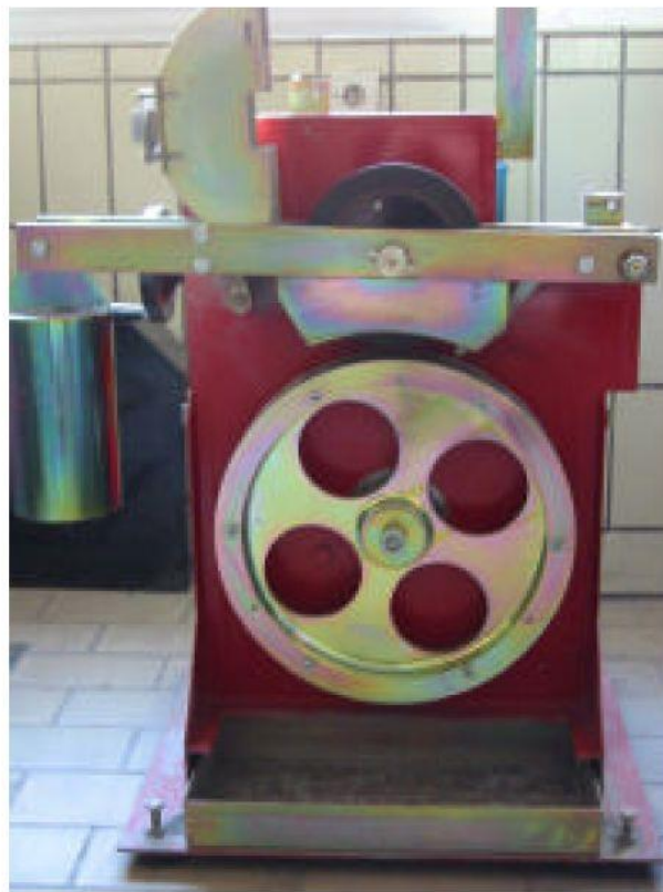
Abb. 3-5: Poliersimulator nach BS 812:1975 (Foto: Pfeiler) bzw. [FSV, 1986].
