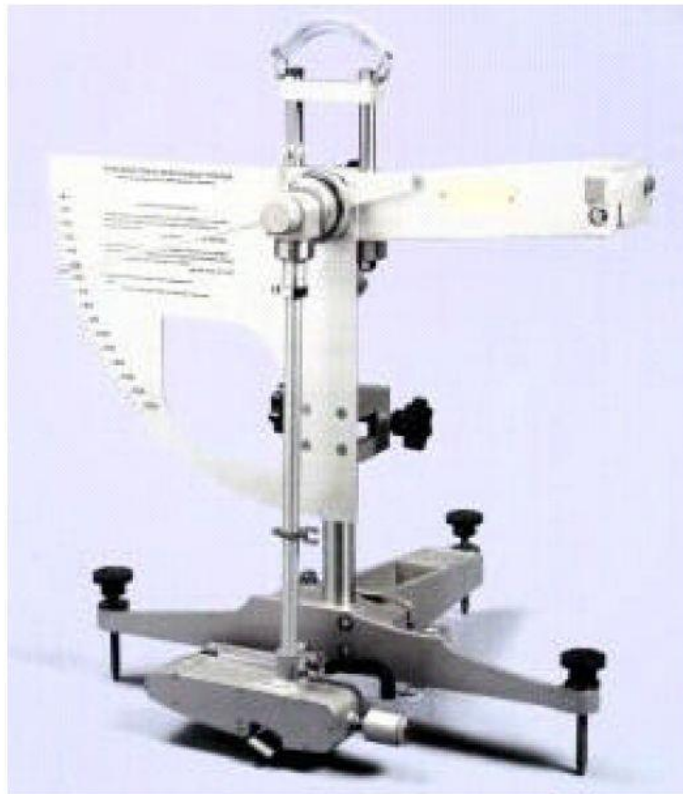
Abb. 3-7: Pendelgerät nach BS 812:1975 [FSV, 1986].
