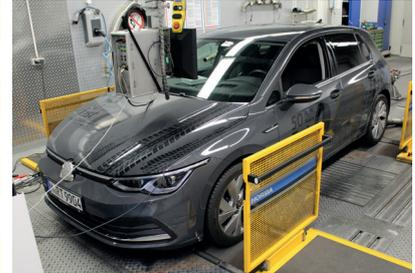
Der hier getestete Golf 2.0 TSI repräsentiert die aktuelle Benziner-Generation mit Turboaufladung, Direkteinspritzung und Ottopartikelfilter. Er erfüllt die finale Euro 6d Abgasnorm. Alle Messergebnisse bestätigen die sehr geringen Schadstoffemissionen des Motors, egal mit welchem Kraftstoff gefahren wird. In allen Zyklen werden die Grenzwerte weit unterschritten.
