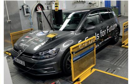
Weiters wurde ein VW Golf VII mit dem 1,4 l Turbobenziner gemessen. Er verfügt noch nicht über einen Partikelfilter, gehört aber zu den technisch aufwendigeren Direkteinspritzern, bei denen über innermotorische Maßnahmen die Partikelemissionen reduziert werden. Obwohl noch nach dem weniger strengen NEFZ homologiert, kann der Golf auch die WLTC-Grenzwerte problemlos deutlich unterschreiten. Mit dem E10 eFuel von CAC ändern sich die Emissionen nur geringfügig und bleiben auch dann gesetzeskonform.
